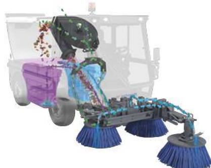
Трехщеточная система со свободно перемещаемой передней штангой обеспечивает ширину подметания до 2 600 мм. Возможна регулировка положения передней щетки влево-вправо, а также подметание на двух уровнях или использование щетки для удаления крупных сорняков.
