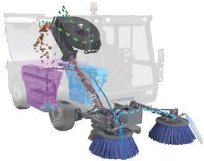
Двухщеточная система с независимо управляемыми лотковыми щетками гарантирует абсолютную мобильность в любых условиях подметания. Две прочные штанги с интегрированными демпферами обеспечивают рабочую ширину до 2 900 мм.
