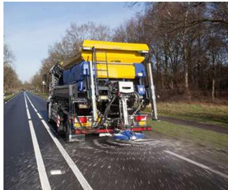
Der Stratos 50 ist ein Aufbau-Streugerät mit einer Behältergrösse von 5 m<sup>3</sup>.
