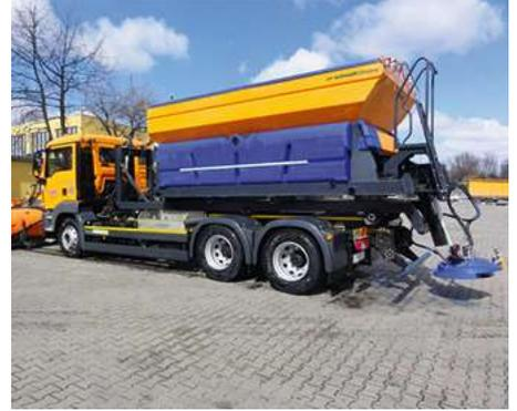
Der Stratos 100 ist ein Aufbau-Streugerät mit einer Behältergrösse von 10 m<sup>3</sup>.
