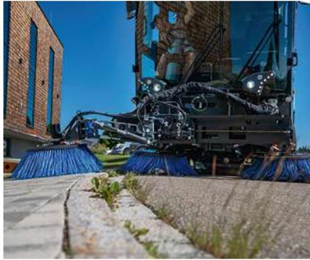
Mit dem optionalen dritten Besen kann die Arbeitsbreite auf 3 550 mm vergrößert werden. Dies ermöglicht eine grössere Flächenleistung und das Kehren auf zwei Ebenen.
