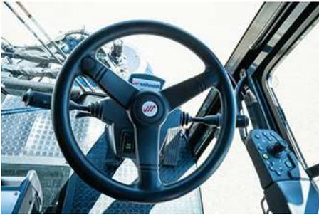
**Tutti i comandi** - compreso il joystick per la gestione dell'unità spazzante - sono **facilmente raggiungibili** dal sedile di guida a sospensione pneumatica e possono essere **azionati con una sola mano**. Il design moderno e il display touchscreen rendono l'interfaccia utente davvero unica. La tastiera con illuminazione LED integrata, montata direttamente davanti al joystick, permette di gestire le funzioni chiave della macchina.
