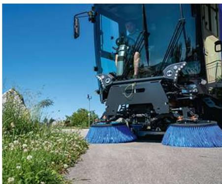
Un sistema di spazzamento flessibile contribuisce a garantire una pulizia accurata in qualsiasi situazione. Completamente trainato e montato davanti all'assale anteriore, permette di raggiungere una larghezza di spazzamento di 2.200 mm.
