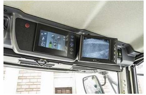
Die Kehreinheit wird über die Türbedienkonsole mit Joysticks und Drucktasten gesteuert. Mit der **Auto-Drive Option** können über den ergonomisch geformten multifunktionalen Fahrhebel alle Kehr-funktionen sowie die Fahr-befehle im Kehrmodus bequem bedient werden. Fahren und Kehren aus einer Hand bedeutet mehr Sicherheit und weniger Stress.
