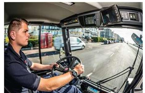
Die wichtigsten Informationen sind auf einen Blick auf dem **Farbdisplay in der Dachkonsole** sichtbar. Zusätzlich kann ein Mechaniker im Display maschinen-spezifische Einstellungen vornehmen. Mithilfe des **Onboard-Diagnose-Systems** sind eventuelle Störungen schnell und effizient zu lokalisieren.
