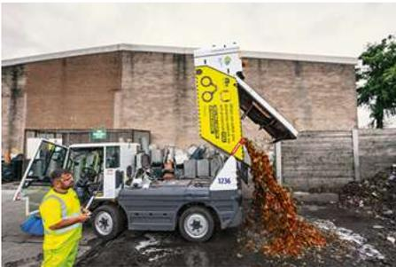
Der Kehrgutbehälter mit einem Systemvolumen von 2 m<sup>3</sup> ermöglicht maximale Kehrgutaufnahme und einen grossen Aktionsradius. Der Kehrgutbehälter besteht aus korrosions- und seewasserbeständigem Aluminium. Eine grosse Auskipphöhe von 1400 mm ermöglicht das Entleeren in alle gängigen Schmutzcontainer. Optional ist das Saugrohr im Behälter aus verschleissfestem Edelstahl verfügbar.
