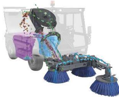
Das 3-Besensystem mit frei bewegbarem Frontbesenarm bietet eine Kehrbreite bis zu 2.600 mm. Links-Rechts-Ausrichtung des Frontbesens ist genauso möglich wie Kehren auf zwei Ebenen oder schwerer Wildkrautbeseneinsatz.
