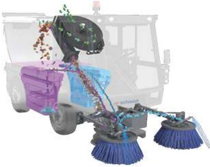
Das 2-Besensystem garantiert mit unabhängig voneinander steuerbaren Tellerbesen absolute Beweglichkeit in jeder Kehrsituation. Zwei stabile Besenarme mit integrierten Anfahrpuffern ermöglichen Kehrbreiten bis zu 2.900 mm.
