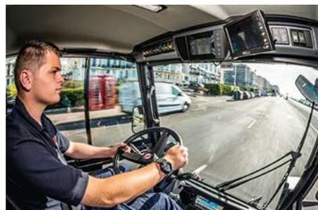
Le informazioni più importanti sono rese immediatamente visualizzabili sul **display a colori, integrato nella console del tetto**. Con **l'ausilio del sistema di diagnosi di bordo**, eventuali guasti possono essere localizzati in modo rapido ed efficiente, mentre un meccanico può effettuare impostazioni specifiche della macchina tramite il display.
