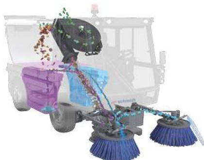
Il sistema a doppia spazzola, con spazzole circolari a controllo indipendente, garantisce una mobilità assoluta in ogni situazione di spazzamento. Due stabili bracci portaspazzole, con respingenti integrati, consentono larghezze di spazzamento fino a 2.900 mm.
