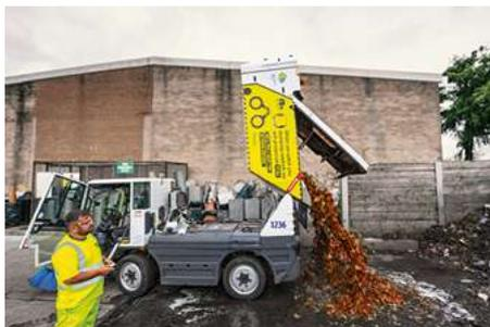
La tramoggia, che ha un volume totale di 2m<sup>3</sup>, consente la massima capacità di spazzamento ed un ampio raggio d'azione. La tramoggia è realizzata in alluminio resistente alla corrosione e all'acqua salata. Un'ampia altezza di scarico di 1400 mm consente lo svuotamento in tutti i comuni contenitori per la spazzatura. Il tubo di aspirazione nella tramoggia è disponibile opzionalmente in acciaio inossidabile, resistente all'usura.
