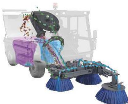
Il sistema a 3 spazzole, con braccio della spazzola anteriore liberamente spostabile, offre una larghezza di spazzamento fino a 2.600 mm. Sono possibili l'allineamento sinistro-destro della spazzola anteriore, lo spazzamento a due livelli e l'utilizzo di spazzole pesanti.
