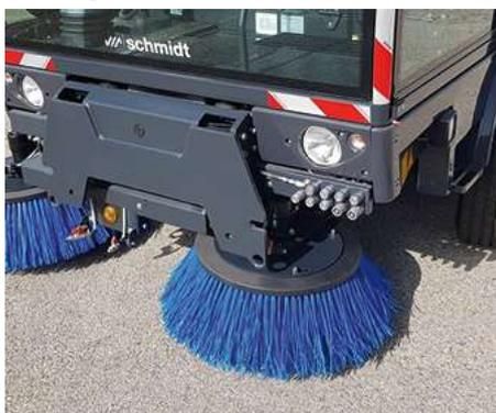
Универсальная система подметания гарантирует чистоту в любой ситуации. Лотковые щетки буксируемого типа, установленные перед передней осью, обеспечивают рабочую ширину 2 200 мм.
