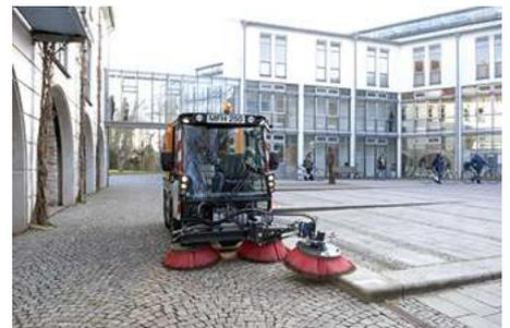
Die zuschaltbare Allradlenkung macht extrem enge Wendemanöver möglich. Die Allradlenkung wird hierbei mittels Lenkwinkelsensoren überwacht, was ein automatisches Zentrieren ermöglicht – anwenderfreundlich und sicher. Standardmässig ist ein hydraulisches Zweikreisbremssystem mit Scheibenbremsen an Vorder- und Hinterachse verbaut.
