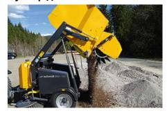
Буксируемые механические подметальные машины MSH оборудованы стальным бункером объемом 0,7 и 1,5 м³. Высота разгрузки составляет 1 500 и 1 800 мм. Бункер опрокидывается гидравлически.
