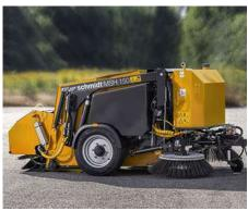
Машины MSH 150 оборудованы стальным бункером объемом 1,5 м<sup>3</sup>.
