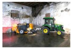
Подметальное устройство машин MSH оборудовано двумя лотковыми щетками буксируемого типа и приводится от BOM трактора. Гидравлическая регулировка подъема и опускания лотковых щеток осуществляется при помощи панели управления. На машинах серии MSH установлена задняя цилиндрическая щетка с системой защиты от столкновения с препятствиями. Регулируемый кожух цилиндрической щетки обеспечивает оптимальные результаты подметания.
