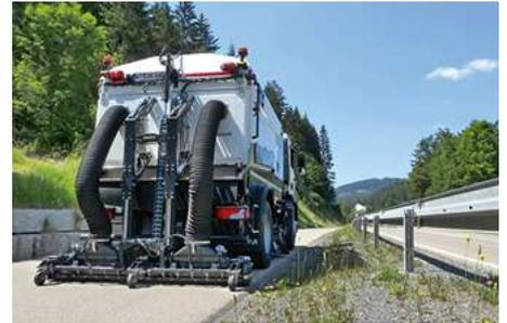
Mit dem Querverschub nach links bzw. rechts wird eine Seitenverstellung beim geradeaus Fahren ermöglicht. Die Hecksaugeinrichtung lässt sich somit näher am Randstein positionieren und die dazugehörige Pneumatikfederung dient gleichzeitig als seitlicher Anfahrschutz. Die Hecksaugeinrichtung ist unabhängig vom LKW-Typ. Die Bedienung ist vollständig in das ES-Bedienpult integriert und ermöglicht eine einfache Steuerung während der Fahrt.
