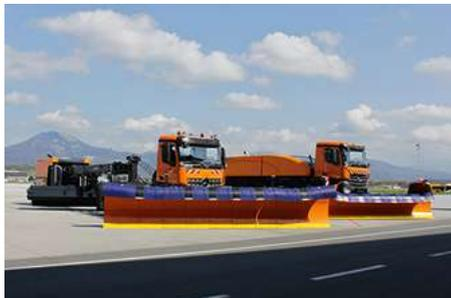
Saubere und aggressive Räumung wird mit den MS Tarron Flughafenschneepflügen, wie zum Beispiel dem MS 56.2 NA, erreicht. Der MS Schneepflug ist für die schnelle Schneeräumung auf Flughäfen abgestimmt und bietet mit optionaler Feinräumleiste, Auswurfssperre oder niedriger Scharform ein ideales Räumergebnis.
