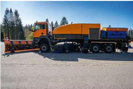
La CJS-DI si monta di serie sul veicolo portante del tipo a telaio MAN TGS 18.320. Questo veicolo portante ha un diametro di sterzata di 18 metri e offre l'opzione di un asse posteriore sterzante aggiuntivo per una maggiore agilità. L'equipaggiamento di base e il livello di emissioni allo scarico (fino a Euro 6) dei motori del veicolo portante devono essere selezionati specificatamente in base a cliente o Paese.
