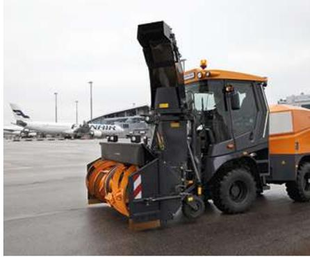
Самоходная фрезерно-роторная снегоуборочная машина Supra 5002 рекомендуется для уборки аэропортов. Ширина захвата машины составляет 2 400, 2 600 или 2 800 мм.
