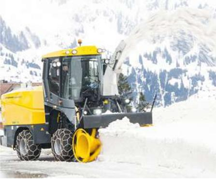
Самоходная фрезерно-роторная снегоуборочная машина Supra идеально подходит для уборки проездов и дорог. Ширина захвата машины составляет 2 400, 2 600 или 2 800 мм.
