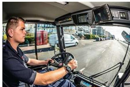
Управление вакуумной подметальной машиной осуществляется при помощи переключателей и кнопок на панели управления в двери. Важная информация незамедлительно отображается на цветном дисплее в потолочной консоли. Кроме того, оператор может выполнять на дисплее индивидуальные настройки машины. С помощью бортовой системы диагностики можно быстро и эффективно локализовать любые неисправности.
