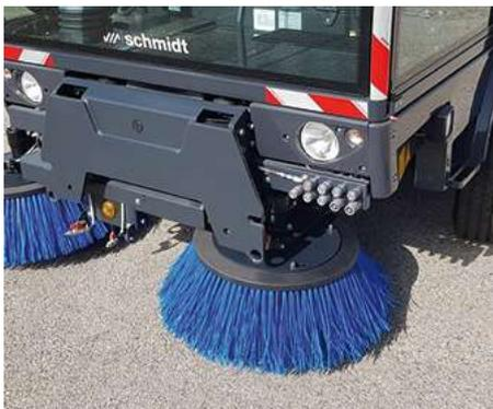
Un sistema di spazzamento flessibile garantisce un risultato pulito in ogni situazione. Il sistema di spazzole a disco trainate montato davanti all'asse anteriore ha una larghezza di spazzamento di 2.200 mm.
